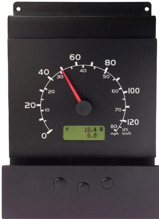
**Einbaumodul für Mercedes Sprinter. Der Antrieb erfolgt direkt über einen HALL Impulsgeber oder CAN Bus der digitalen Tachographen. Die Stromversorgung kommt über das Fahrzeug. Über die drei Drucktasten kann ein Tageskilometerzähler oder die Uhrzeit angezeigt werden.**
